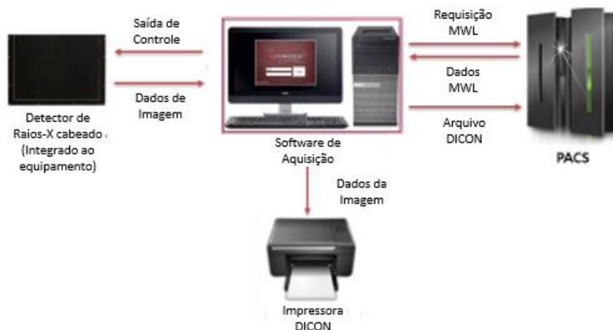
Figura 82 - Diagrama de conexão do software de aquisição de imagens
